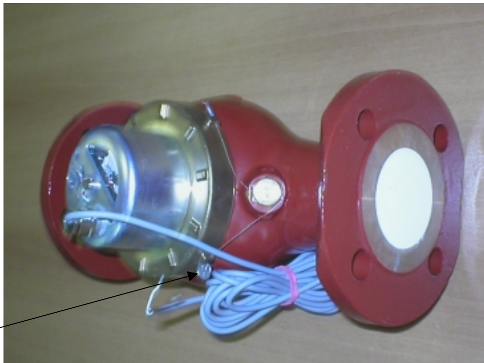
Slika 2: Prikaz stavljanja znaka ovjere na mjerilo protoka mjerila toplinske energije tipa MTH-DA-KGm
